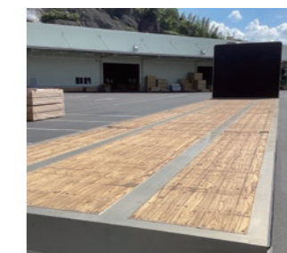
トラック荷台部分のスギの床板
