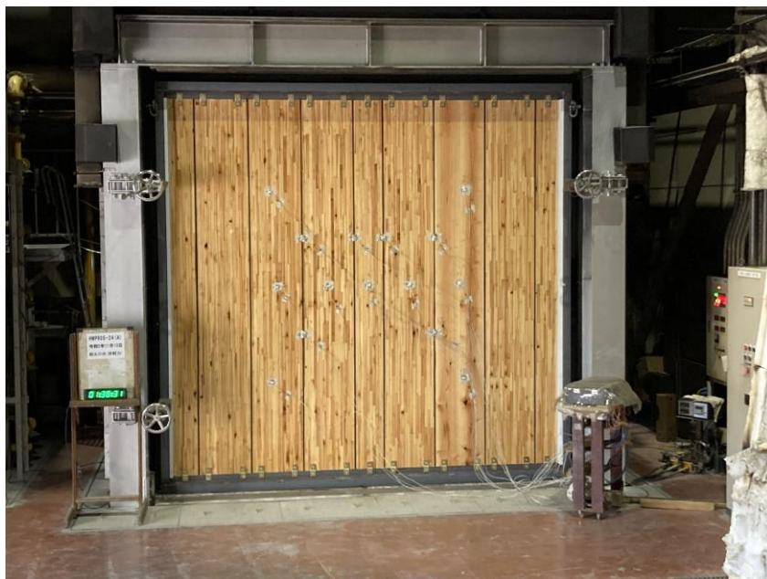
性能評価試験（燃焼実験）の様子
